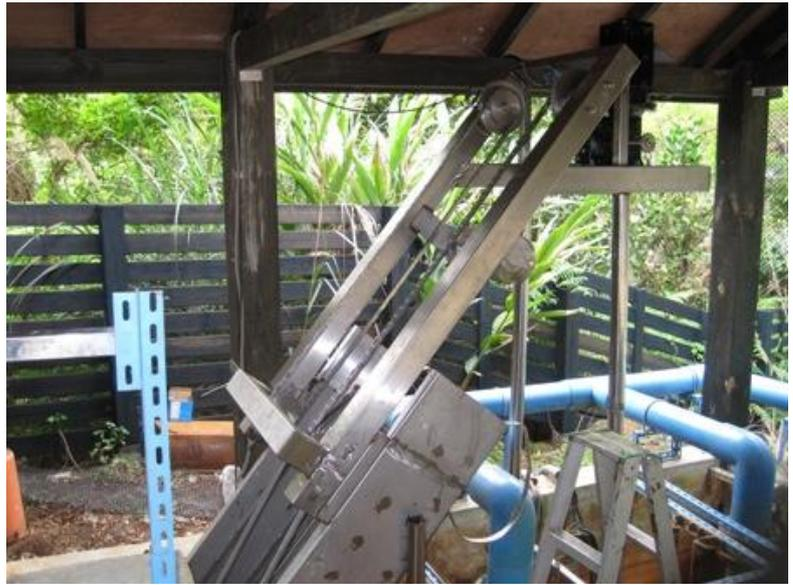
是水面上的污物的功能，以防止污物進入後續處理系統，免除後續處理系統可能遭受之效率降低或機械損壞的問題。
